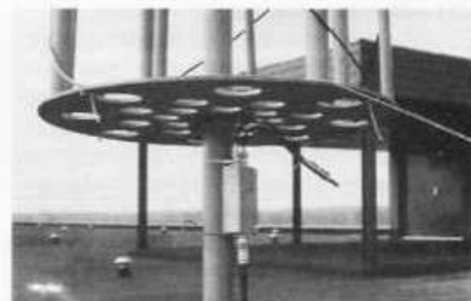
Foto 6. Beide coaxiale antennekabels sluiten we (denk om het kwart golflengte kabeltje), aan op de door mij gebruikte antenneversterker. Cilinderlengte: 1091 mm = 0,5 golflengte. Doorsnede: 568 mm. L/D-verhouding 1,92. 3/4 slag gedraaid. Halve dipool van 1 golflengte. Metingen volgens Kilgus: 3dB beam = 180 graden. F/B-ratio 14 dB. 3 dB axiale ratio 7 dB.
