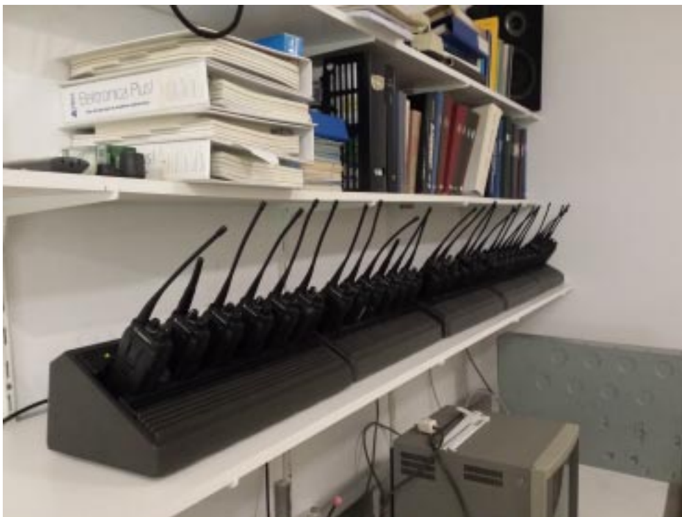
DARES R12 Kennemerland heeft altijd 30 portofoons paraat welke via de 70cm repeater PI2HLM een zeer groot bereik hebben, namelijk heel Noord-Holland en een groot deel van Zuid-Holland en Midden-Nederland .
